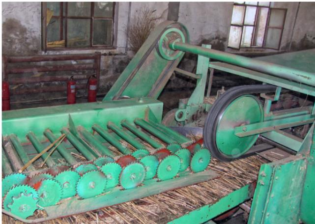
In dieser Maschine werden die Stängel im „Brecher“ verarbeitet, um die Bastfasern vom inneren Holzkern zu lösen.
