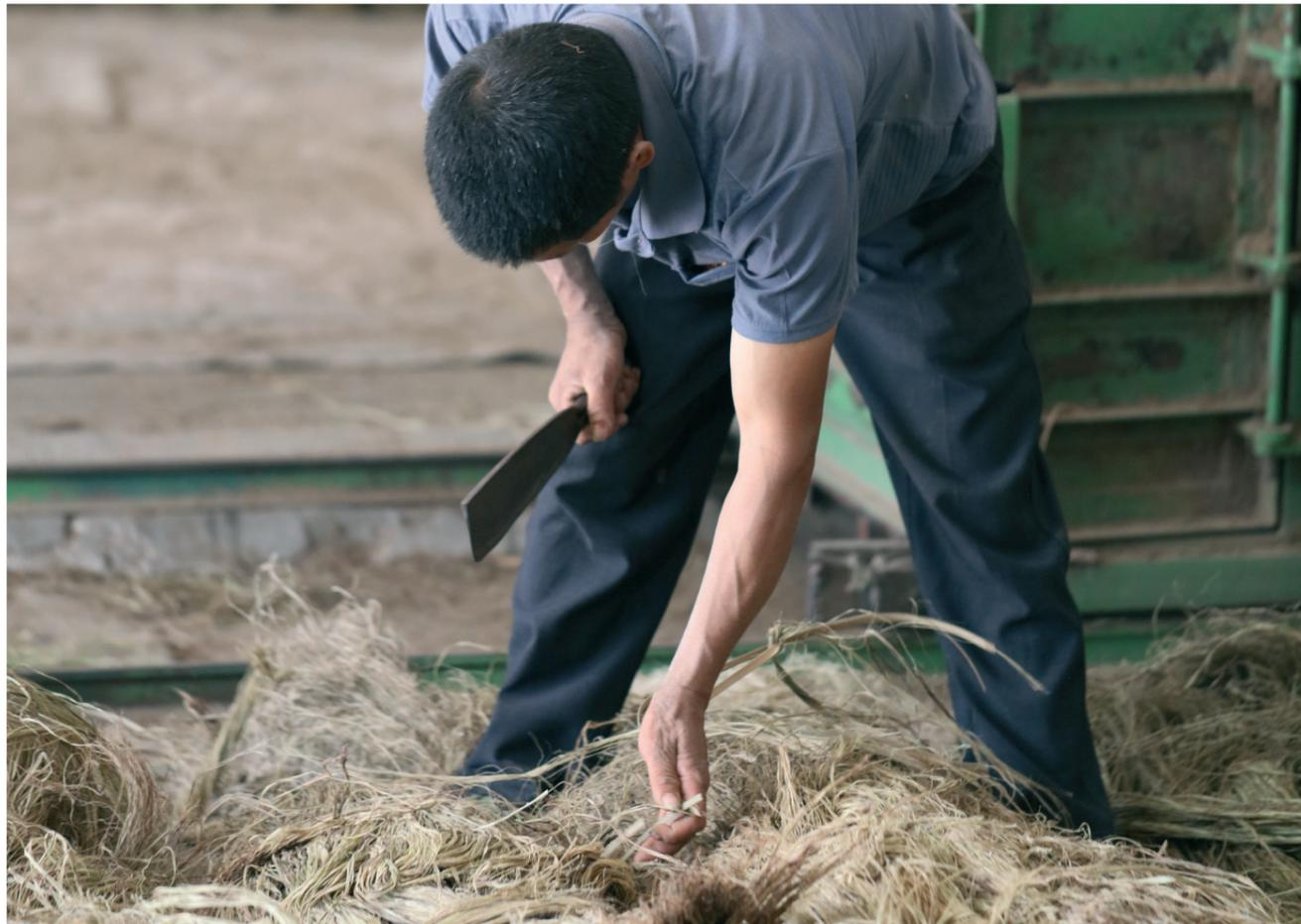
Getrockneter Ramie wird zur Pressung fertig gemacht.
