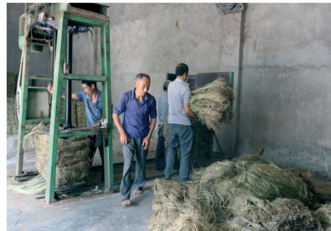
Ramie wird zu Ballen gepresst und aufgestapelt.
